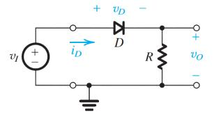
FIG 13. A rectifier circuit
